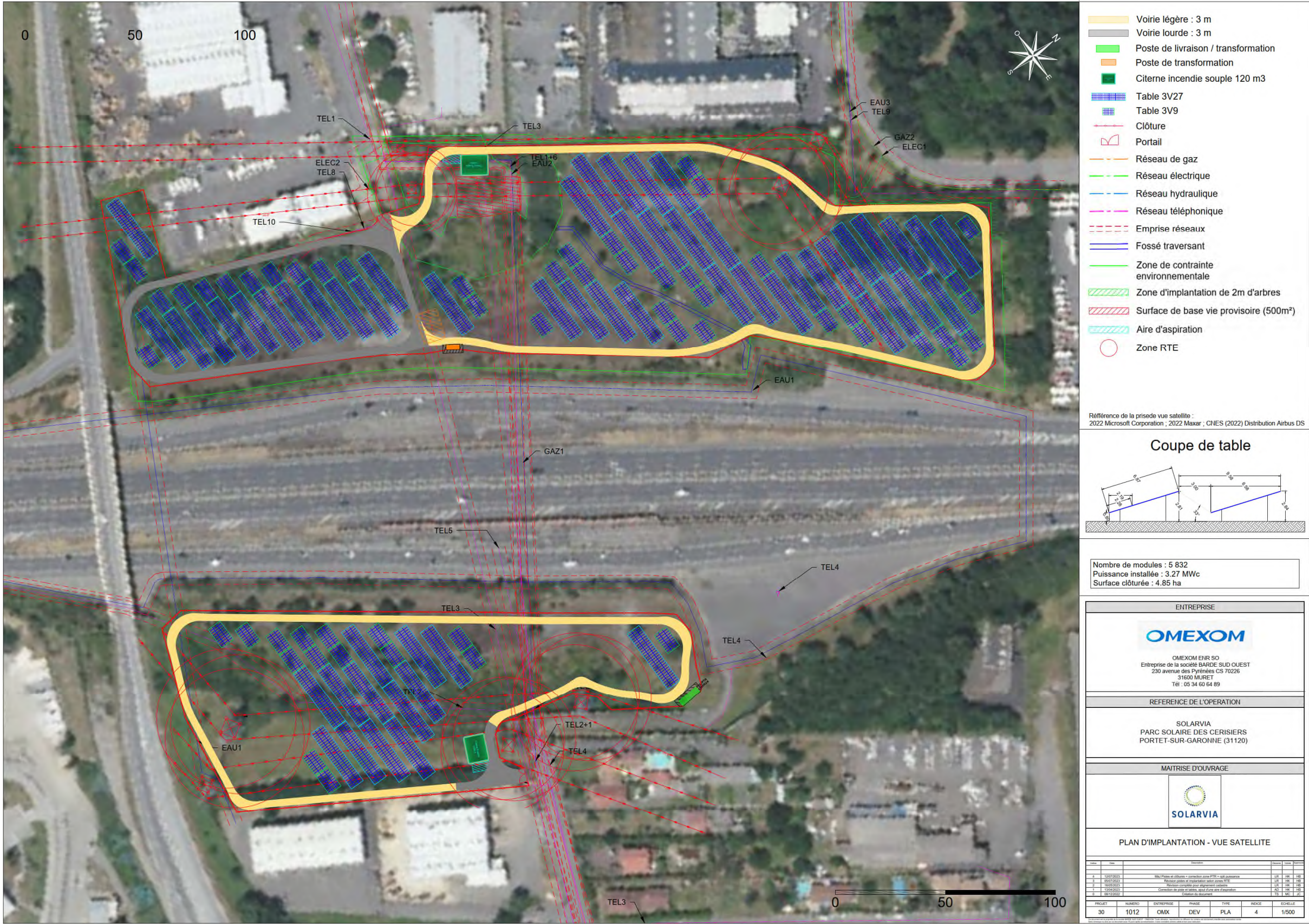
Figure 3 : Présentation du plan de masse du projet du parc photovoltaïque des Cerisiers
